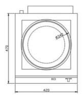
技术要求: 1.产品外形: 420X(470+50)X235 2.产品功率: 5KW/220V.
